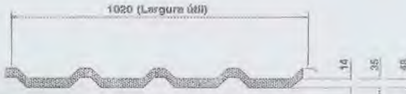
Figura 02: Telhamento em chapa de aço com pintura em poliéster, tipo sanduíche.
